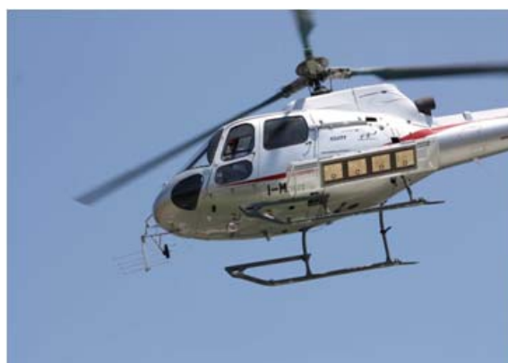
Figura 6 Elicottero con sensore a bordo, in evidenza l'antenna SAR.
