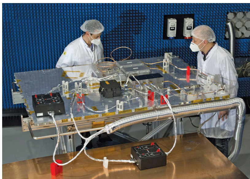
In alto: il satellite del programma Juice per l'esplorazione delle lune di Giove Sopra: il radar "sunder" RIME (sviluppato da Thales Alenia Space) in Clean Room
