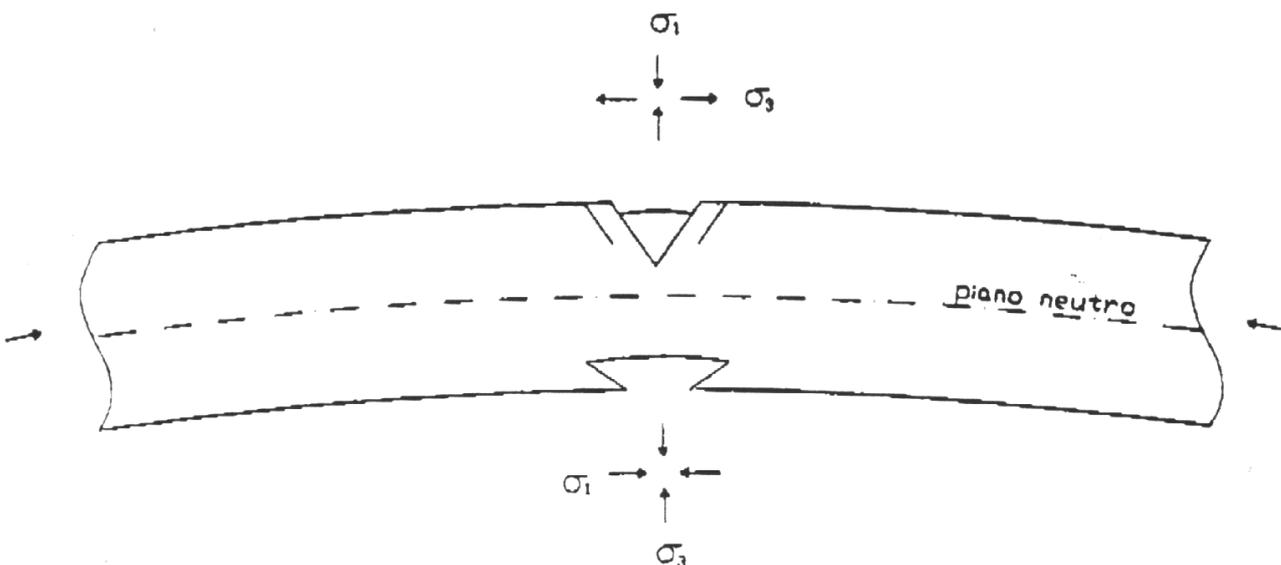
Fig. 11 - Schema degli sforzi agenti in una piastra sottoposta ad un processo di *bending* e relative deformazioni. Nella parte superiore del piano neutro prevalgono deformazioni distensive mentre nella parte inferiore si sviluppano compressioni.
