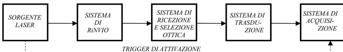
FIG.4.3:Schema a blocchi di un apparato Lidar
