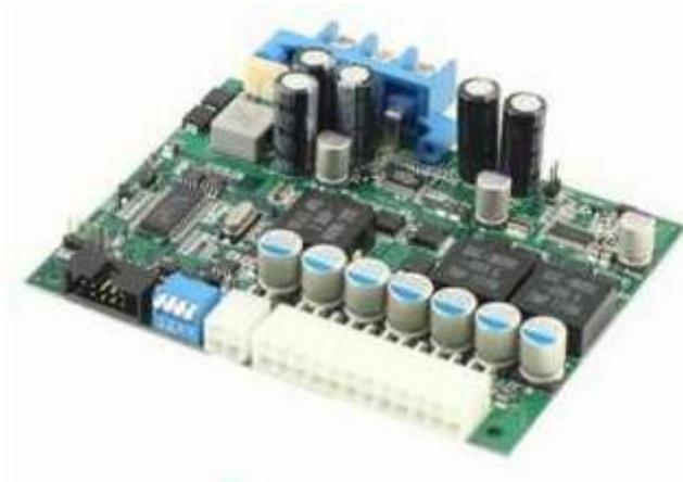
**Figura 2- 9:** Alimentatore ATX
