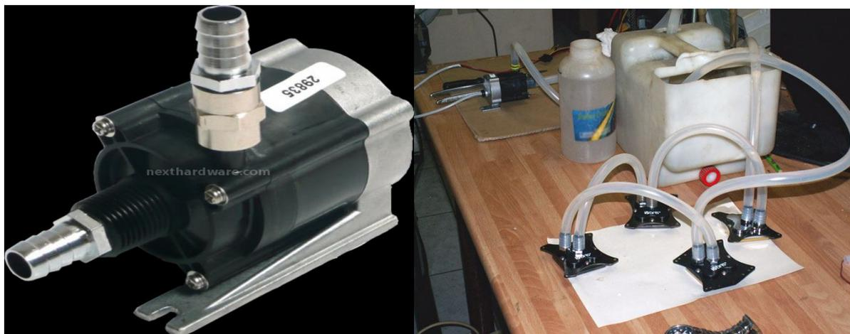
**Figura 3- 13:** Sanso PDH 54 e foto del test con 4 waterblock in serie
