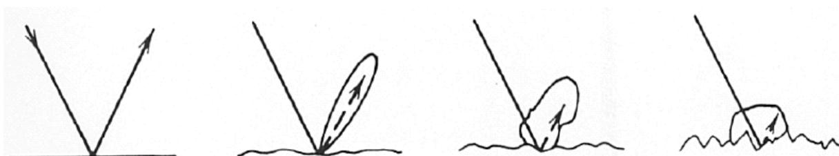
**Figura 6.1 : risposta delle diverse superfici al fascio radar (a),(b),(c),(d)**
