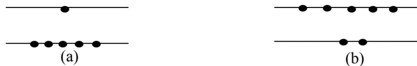
**Figura 1.1.3: Due livelli di energia per un insieme di atomi. Ogni punto rappresenta lo stato energetico di un atomo. (a) situazione normale (b) inversione di popolazione**
