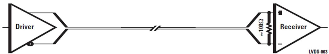
Figura 51 - Configurazione Point-to-Point
